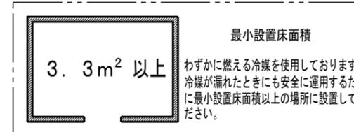
わずかに燃える冷媒を使用しております。冷媒が漏れたときにも安全に運用するために最小設置床面積以上の場所に設置してください。
