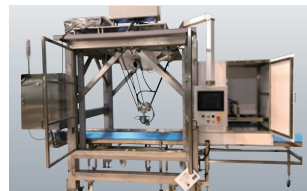
包装機投入ロボットシステム
