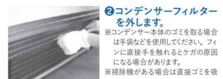
② コンデンサーフィルターを外します。※コンデンサー本体のゴミを取る場合は手袋などを使用してください。フィンに直接手を触れるとケガの原因になる場合があります。※掃除機がある場合は直接ゴミを吸い取ってください。
