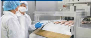
トンネルフリーザーの実機で食品の冷却・凍結試験。
