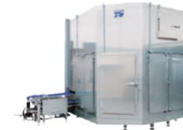
コンベアを螺旋状に搬送させる連続式スパイラルフリーザーです。機械面積あたりの生産量が多く、省スペースながら大量の商材を冷却、凍結することが可能です。
