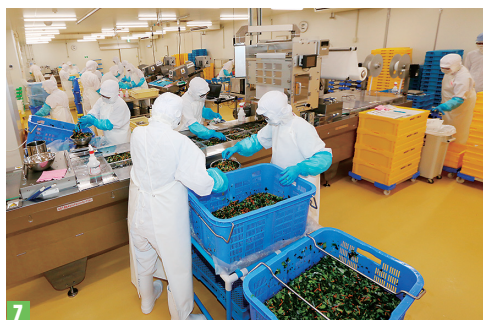
5 ブラストチラーは計6台。調理したものを直ちに冷却することで菌数を制御している／ 6 真空冷却機は3台。扉の取っ手にカウンタークロスを巻き付け、次亜塩素酸ナトリウムでぬらし、汚染源を抑えている／7 包装室。深絞り真空包装機。フィルムの上に定量の食材を載せて真空包装する／8 検品システム。バーコード検品を採用し、検品精度を向上させた。固定式スキャナーでバーコードを読み込み、施設ごとに全商品がそろっているかを確認。その様子はカメラで録画し、施設から問い合わせがあった際にはさかのぼって画像データをチェックし迅速に対応する
