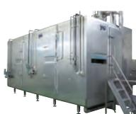
高圧チャンバーから均一に送られた冷風で商品をバランスよくフローティングさせ、各表面から凍結させるバラ凍結専用機です。ミックスベジタブル等の野菜をはじめ、ほうれん草やミンチ肉、冷凍ピラフ等米飯など、小型から大型まで幅広く使用されています。
