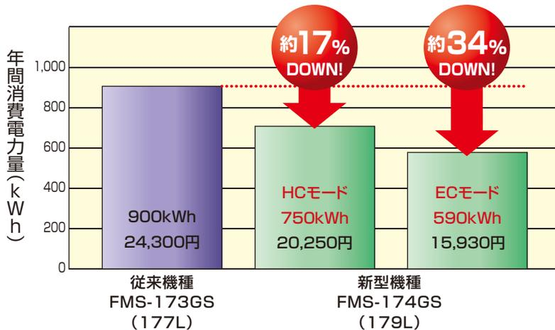
※年間消費電力量は、周囲温度30℃、湿度60%、電源周波数60Hz、電源電圧100V、設定温度5℃、無負荷、扉開閉無しで得られた値を表示しております。
