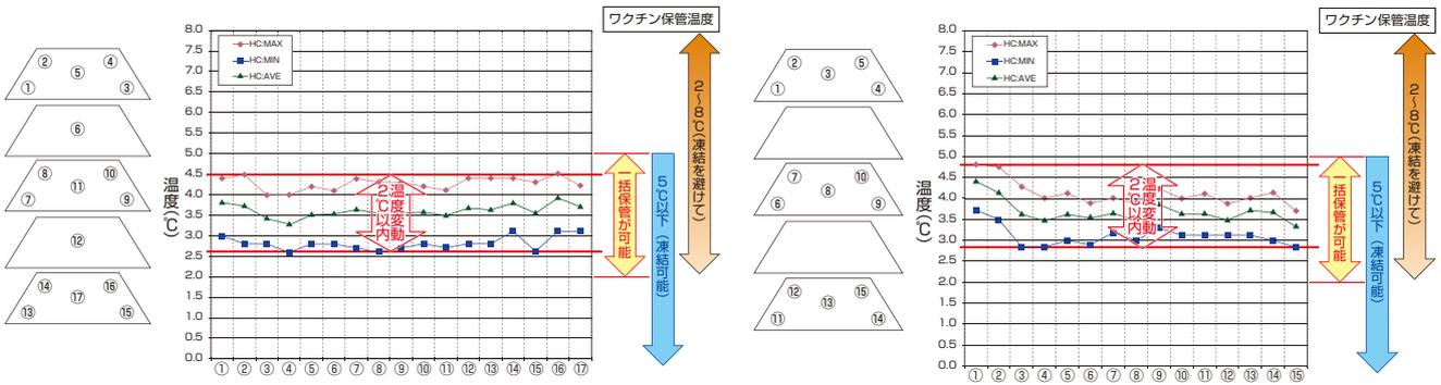
FMS-174GS 設定温度: HCモード 3℃ 周囲温度: 30℃ 周囲湿度: 60%
