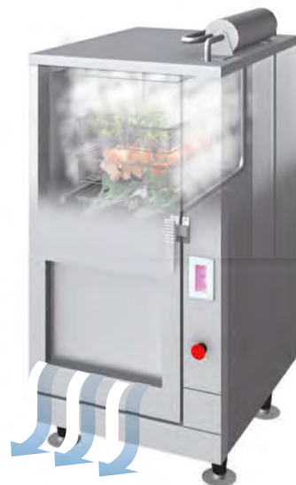
庫内で網カゴがアップダウンし、上部でスチームします。
