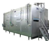
IQF専用のトンネルフリーザー。高圧チャンパーから送られた冷風で商品をバランス良くフローティングさせ、各表面から凍結させるバラ凍結専用機です。ほうれん草、ミックスベジタブル等の野菜をはじめ、ミンチ肉や冷凍ピラフ、米飯のバラ凍結用として小型から大型まで幅広く使用されています。
