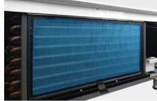
新設定のオプション「フィルター清掃装置(ファン制御方式)」は、霜取り時に凝縮器ファンモーターを制御し、フィルターに付着したホコリを除去。フィルターがきれいな状態を保持でき、省力化と省エネ性の持続を実現します。(METシリーズ)
