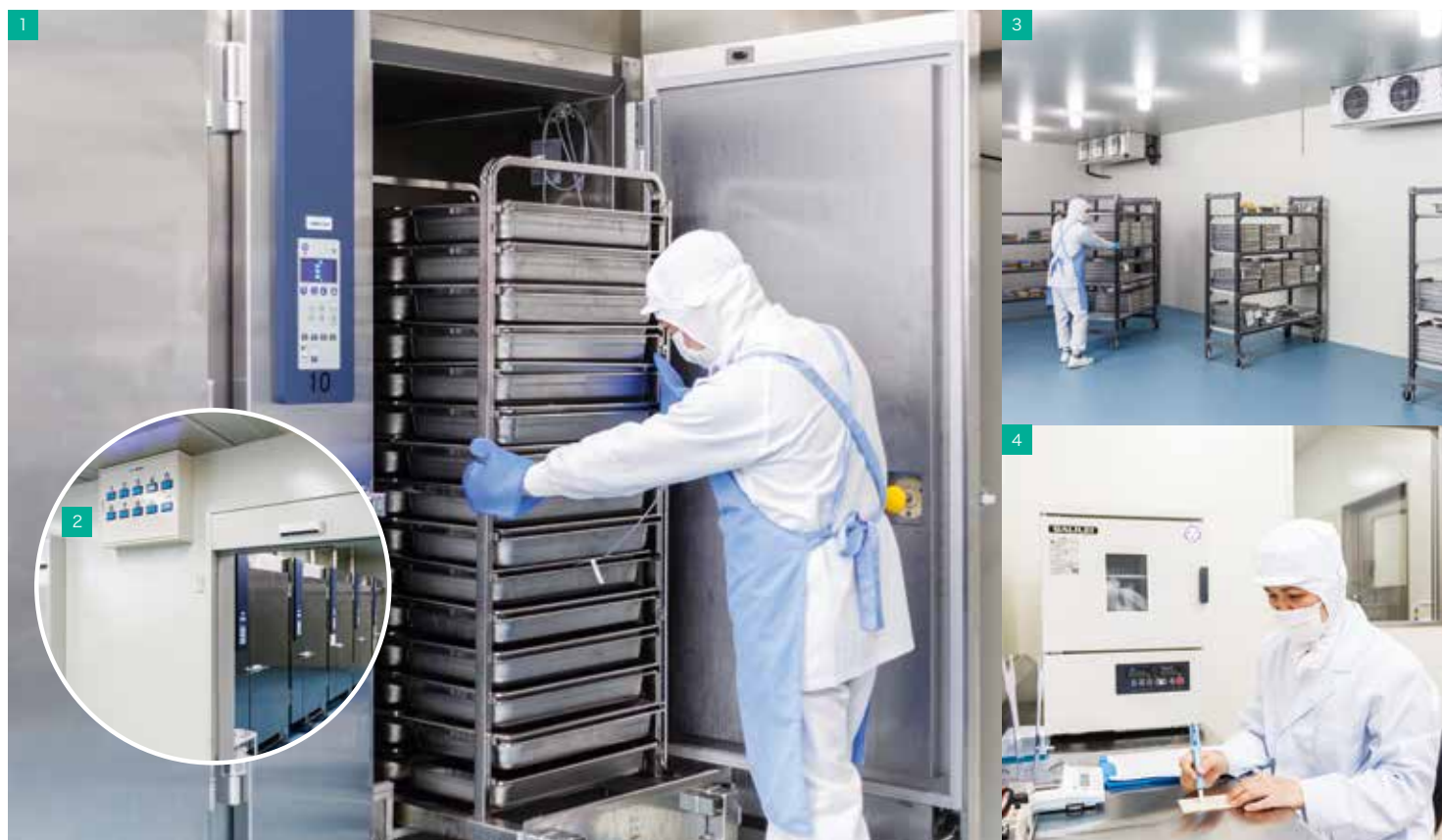
1…40枚のホテルパンを収納し、様々な料理も同時に急速冷却するブラストチラー40型 2…特注のブラストチラー稼働状況表示盤。全10台の運転状況がひと目で分かります。 3…冷却した料理はプレハブ冷蔵庫で保管。温度管理と作業性を重視した設計。 4…低温インキュベーター（後方）で菌を培養させて食品の菌数を検査。1〜2日で結果が分かり、即座に現場へフィードバックできる。
