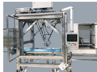
包装機投入ロボットシステム
