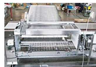
搬送コンベヤ
